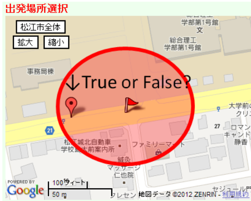
図 4.10: 円形の Buffer と Within メソッドの組み合わせによるバス停検索
