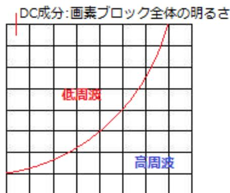
図 3-3. DCT ブロックの各成分
